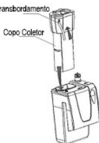
7. Coloque o copo coletor no corpo do Skimer e conecte a mangueira no cotovelo do copo
