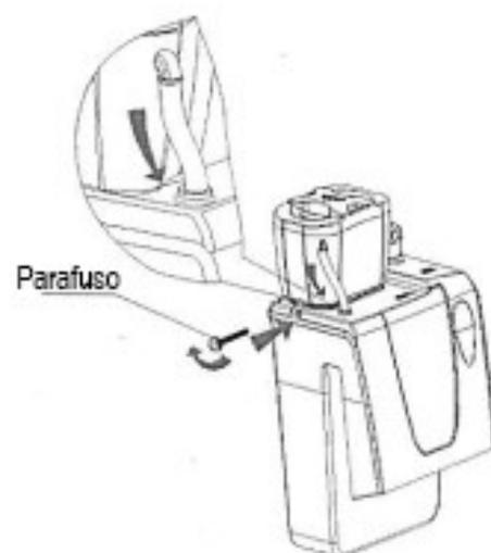
8. Coloque a tampa e o parafuso no copo coletor (Não aperte muito o parafuso para não quebrar)
